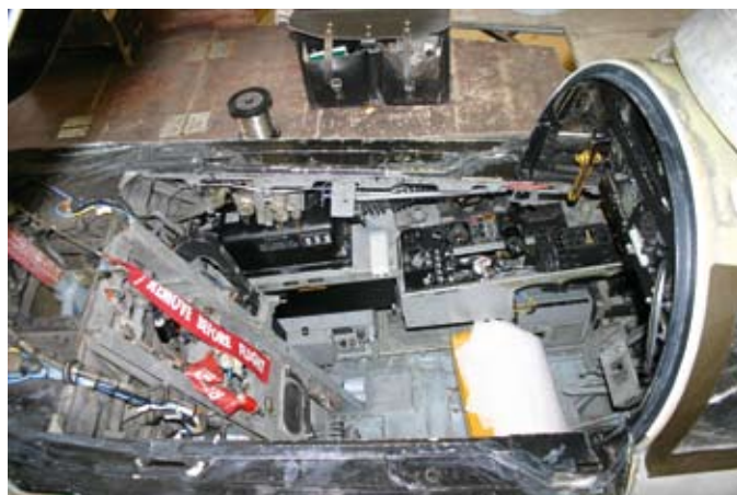
Abb. 8: Teilweise demontiertes Cockpit einer Phantom F-4, der typische Arbeitsplatz eines Elektrikers für Flugtechnische Systeme (die Berufsbezeichnung der derzeit tätigen Facharbeiter lautet noch Fluggerätelekttroniker).
