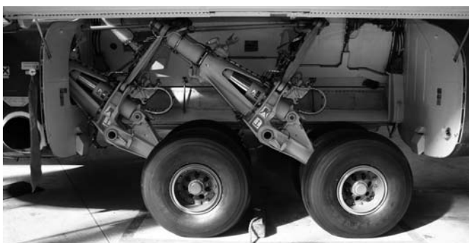
Abb. 6: Teilweise montiertes Fahrwerk einer C 160. Es kann mit Fremdversorgung (Hydraulikdruck, Spannung) auf Funktion und Dichtigkeit getestet werden. Später, wenn der gesamte Flieger bis zur technischen Flugtüchtigkeit montiert wurde, werden alle Systeme noch einmal getestet.
