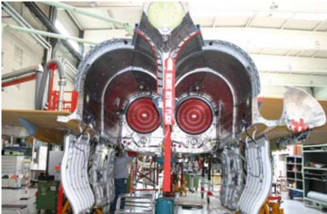
Abb. 9: Rumpf eines Eurofighters, vorbereitet zum Einbau der beiden Strahltriebwerke.
