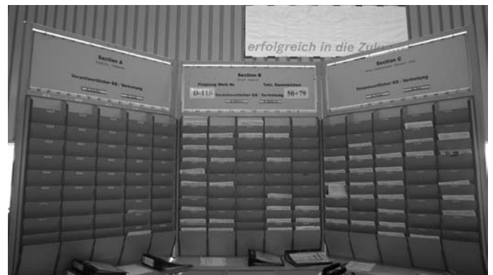
Abb. 3: Instandhaltungsplatz einer C 160 (Transall): Hier sind die Arbeitsaufträge auf Basis der erfolgten Befundung formuliert, sie werden im Prozess der Instandhaltung sukzessive ergänzt.
