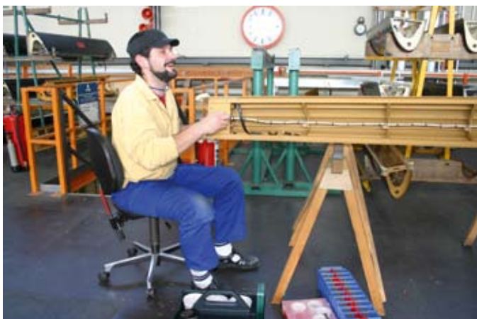
Abb. 5: Handarbeit bei der Instandsetzung von großen Strukturbauteilen.
